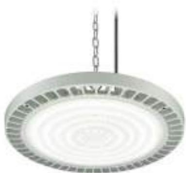
La luminaria puede instalarse en la red existente y la conexión eléctrica es sencilla: no es necesario abrir la luminaria para su instalación y el conector externo IP65 facilita su manejo. Hay disponible una selección de accesorios opcionales, como reflectores y un soporte para aumentar aún más la flexibilidad de la instalación.
