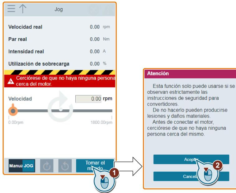
3. Haga funcionar el motor en modo JOG o HAND (modo predeterminado: JOG). Tenga en cuenta que, si lo desea, también puede probar la dirección de rotación del motor con el botón correspondiente ("①"). En la página se muestra la dirección de rotación seleccionada actualmente ("②").
